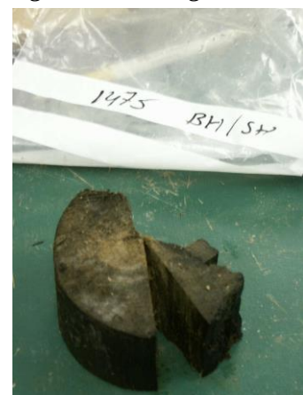
Figuur 3-1; één van de monsters zoals ze bij NISA genomen zijn. Te groot voor de microtoom.
