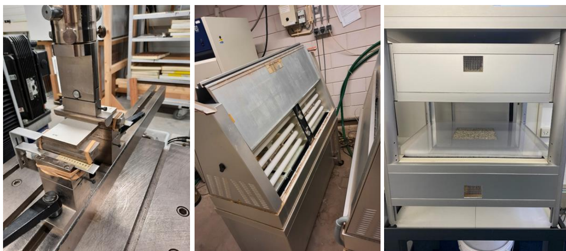
Figuur 5: testopstellingen bij SHR voor bepalen van (v.l.n.r.): mechanische eigenschappen, UV-bestendigheid en warmtegeleidbaarheid.
