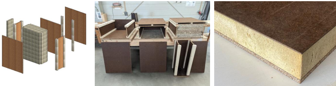
Figuur 7: verschillende prototypen bouwelementen met v.l.n.r.: ontwerp-tekening van het gevelelement, verschillende gevelelementen in wording en een dak element o.b.v. bioschuim sandwich.
