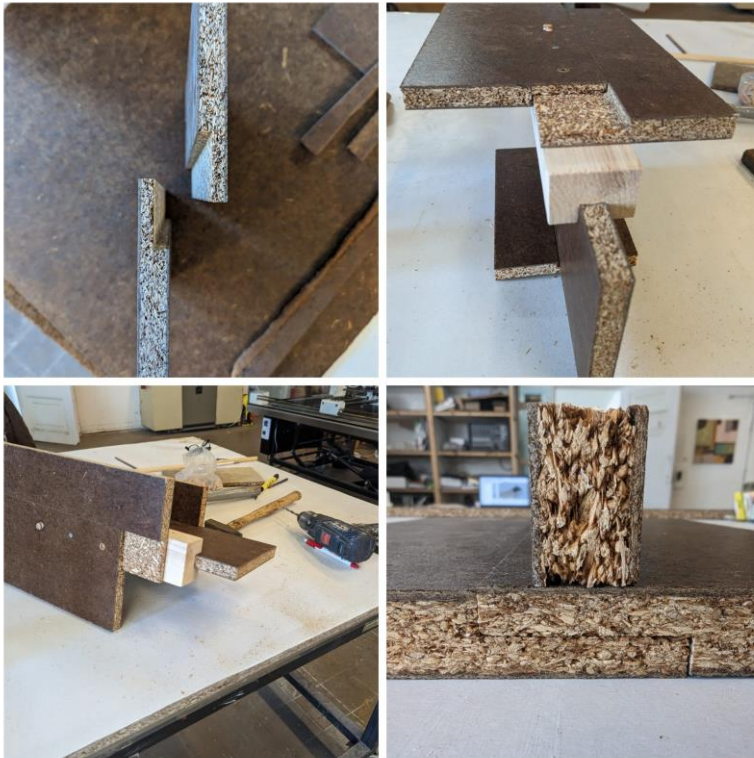
Figuur 8: voorbeelden van geteste verbinding methoden; boven v.l.n.r.: lijmverbinding sandwichpaneel, verschillende schoeven en spijkers om sandwichpaneel aan I-profiel te verbinden; beneden v.l.n.r.: zijaanzicht verschillende schoeven en spijkers om sandwichpaneel aan I-profiel te verbinden, lijmverbinding sandwichpaneel.
